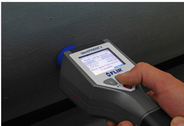
Branduolinių medžiagų saugojimo konteinerio tikrinimas spektrometriu analizatoriumi
